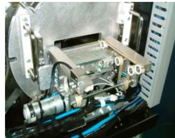
搬入出コンベア部
